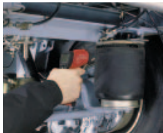
Mitteilsam: Die auf dem integrierten Chip des Luftfederbälgs gespeicherten Produktdaten lassen sich per Funk abrufen und sogar ergänzen, beispielsweise beim Service. (Foto: ContiTech)
