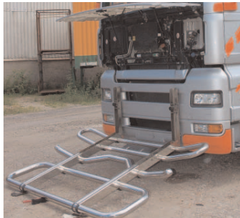
Der Edelstahlbullfänger lässt sich mit wenigen Handgriffen abschnellen, um die Frontklappe zu öffnen.
