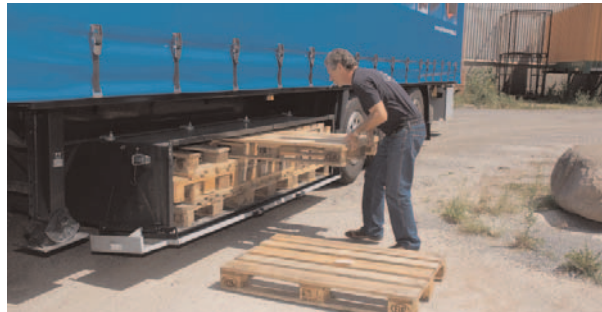
Problemlos und pfiffig: Die glattflächige Klappe des HS-Palettenkastens verschwindet für ein bequemes Be- und Entladen unter dem Stauraum.
