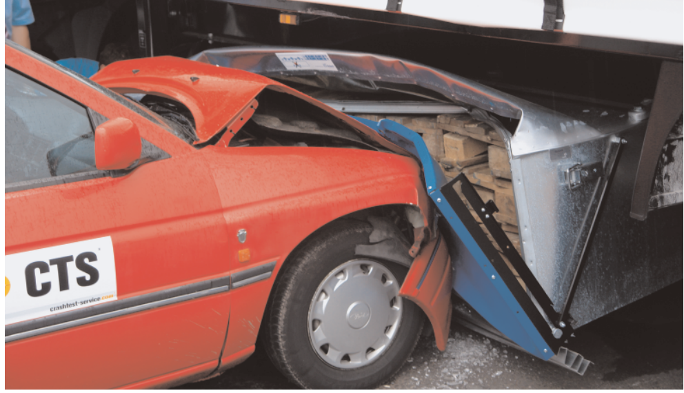
Bewies im Crashtest erstaunliche Nehmerqualitäten: der Palettenstaukasten von HS-Schoch
