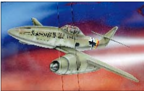
Die Messerschmitt Me 262 hatte als erstes Militärflugzeug Strahltriebwerke.
