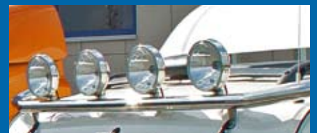
Scheinwerferbügel oben* Normaldach Artikel-Nr. 16503039 mit Schellen Artikel-Nr. 16503043
