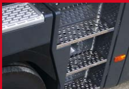
Renault Magnum Auftrittsatz Edelstahl (3-teilig), rechts und links einsetzbar, Teile-Nr. 5021 018 752
